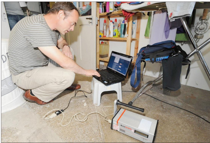
AU SOUS-SOL Robert Gaisch réalise une première analyse afin de définir les zones d'infiltration du radon.
